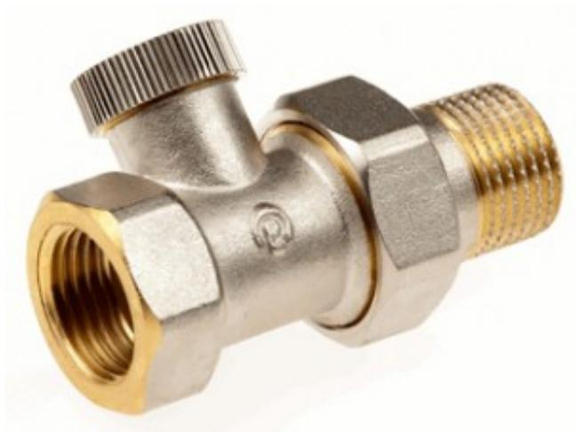
Клапан обратного потока служит для монтажной настройки расчетного расхода теплоносителя через отопительные приборы систем водяного отопления.
