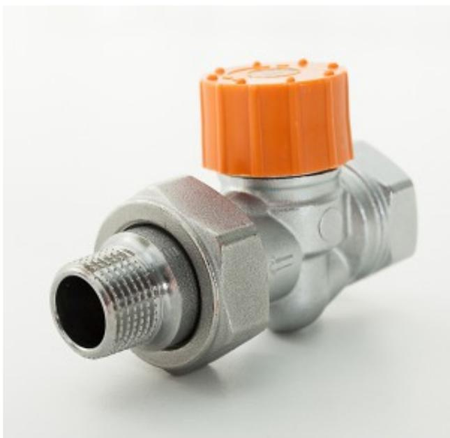
Клапан термостатический предназначен для подсоединения радиатора к системе отопления и индивидуальн автоматического (необходима термостатическая головка) регулирования подачи теплоносителя в радиатор с целью поддержания температуры в помещении на заданном уровне и экономии энергии.
